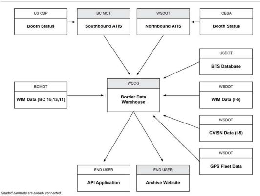
BORDER DATA WAREHOUSE UPGRADE PROJECT ARCHITECTURE SCHEMATIC
